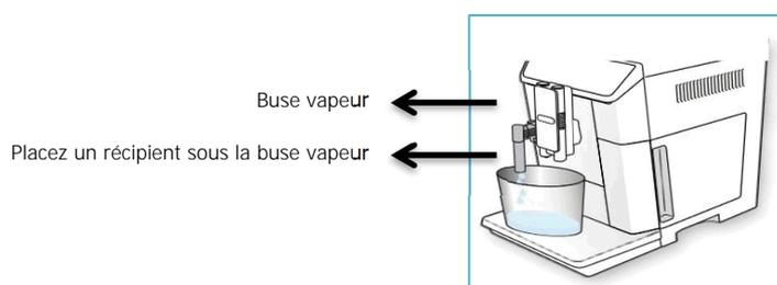
Si vous entendez ce genre de bruit alors que le réservoir est rempli et que tout semble normal, il est possible qu'il y ait un peu d'air dans le circuit hydraulique de l'appareil. Un amorçage de la pompe est nécessaire. Il suffit alors de bien suivre les étapes suivantes:
